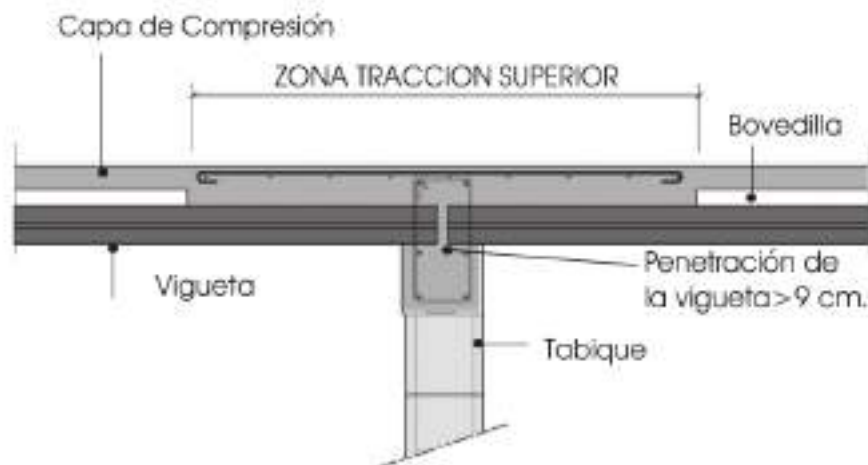
Figura 37 Refuerzo de losa continua de viguetas
